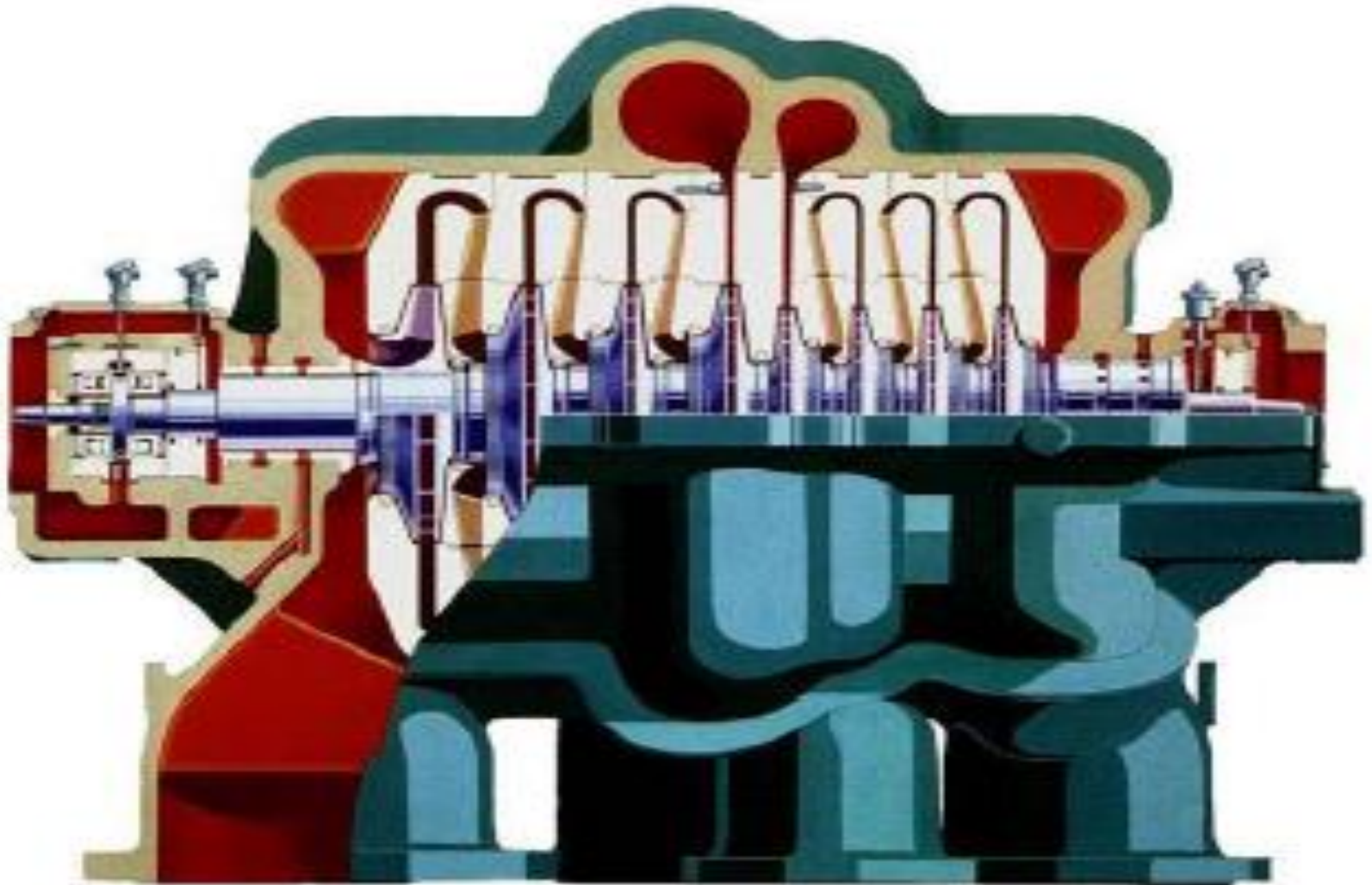
شکل ۲۷- دو نازل خروجی در قسمت وسط کمپرسور
