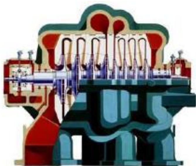
شکل ۴۴- شماتیک یک کمپرسور با خنک کن میانی
