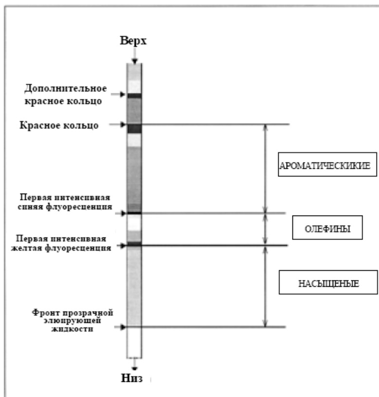
Рис. 3. Иллюстрация для идентификации хроматографических границ проб с кислородосодержащими компонентами топлива
