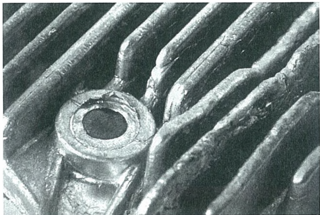
Fig. DCP-16. Misrun.
