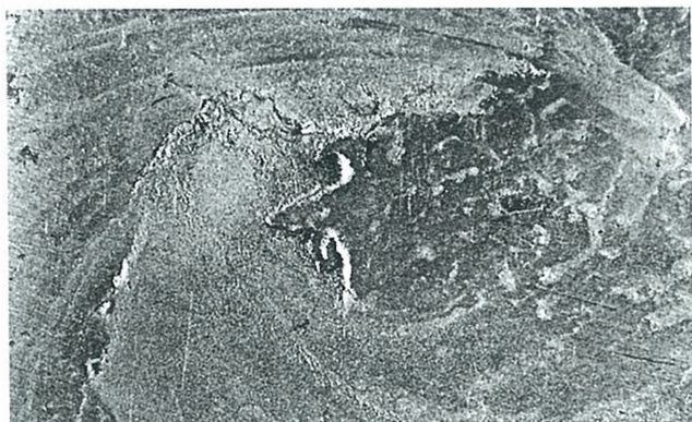
Fig. DCP-2. Cold shut.
