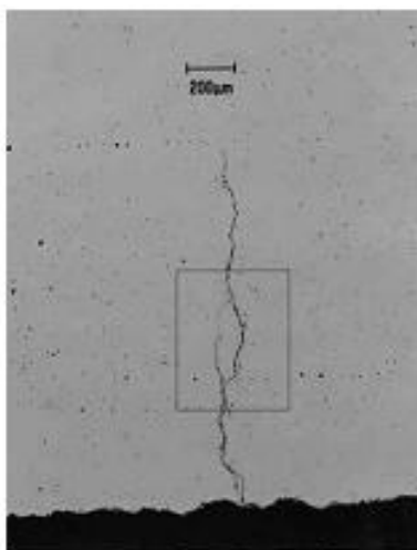
شکل ۱- ترک خوردگی قلیایی در فلز جوش فولاد کربنی - اچ نشده.
