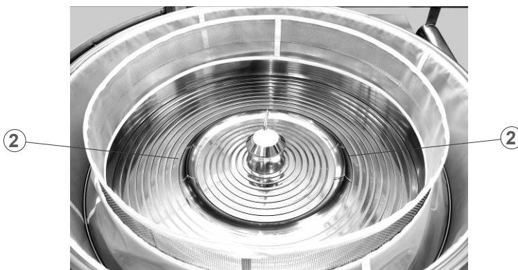
Abb. 5-3 Blick in einen offenen AIRCOATER® auf den Treibsatz Vulcano ® und auf die zwei Sprühdüsen Lineajet ®
