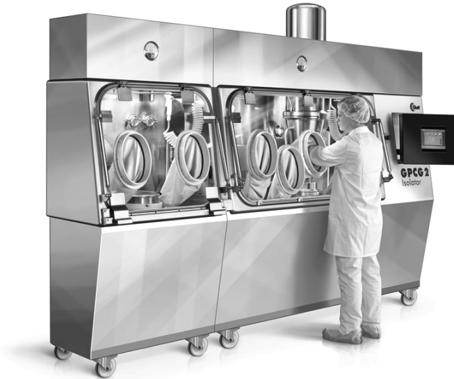
Abb. 4-20 GLATT GPCG 2 in Isolator-Ausführung
