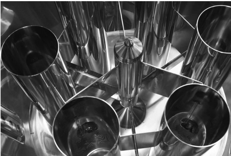
Abb. 4-23 GLATT 46“ Wirbelschicht-Wurster-Produktionsanlage mit 6 Steigrohren und 6 HS-Düsen
