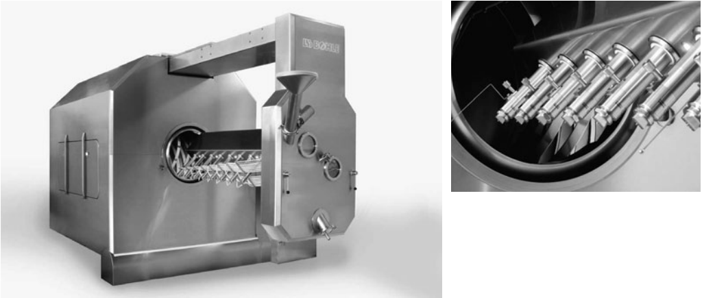
Abb. 3-5 Trommelcoater für den Industrieinsatz (links) mit Sprüheinsatz (rechts) (Fa. Bohle)
