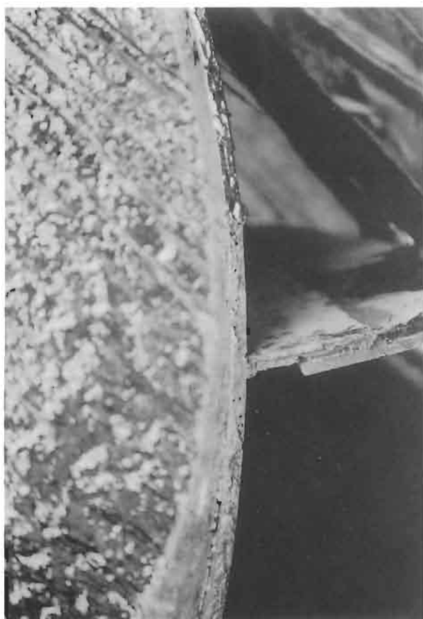
Fig. 10. Port bilge keel-to-keel detail.
