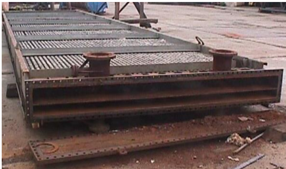
Air Fin Fan Cooler
