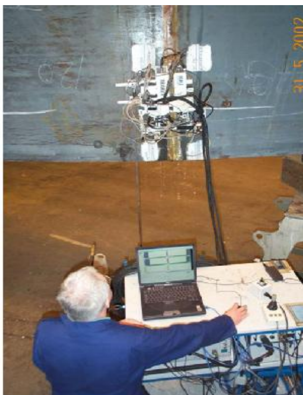
شکل 10: بازرسی یک جوش عمودی با اسکنر دارای چرخهای آهنربایی
