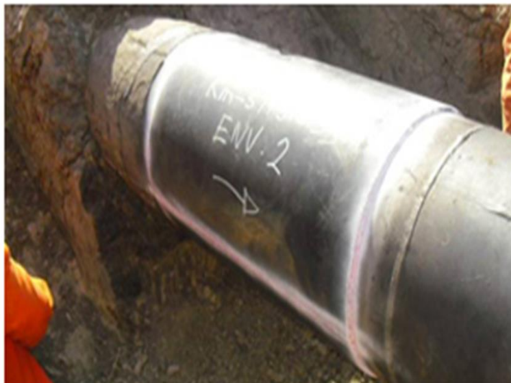
تصویر ۳۰- آزمون مایعات نافذ از سرجوشهای غلاف پس از پایان جوشکاری
