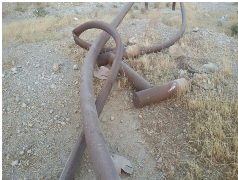
تصویر ۲۵- انفجار خط لوله یکی از مناطق نفتخیز به دلیل برشکاری جابجا در خط لوله
