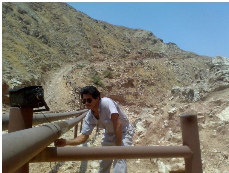
تصویر ۲۹- آزمون آلتراسونیک موضع قرار گیری سرجوشهای غلاف قبل از جوشکاری به منظور اطمینان از ضخامت کافی و عدم وجود عیوب
