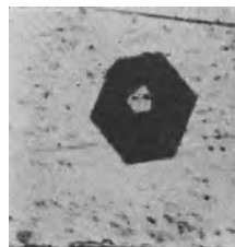
Abb. 23. Nadel von \text{Al}_4\text{Mn} , quer geschnitten, 1000 \times .
