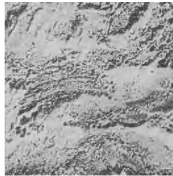
Abb. 79. Flach angeschliffene lamellenförmige Ausscheidungen von Mangan, 900×.
