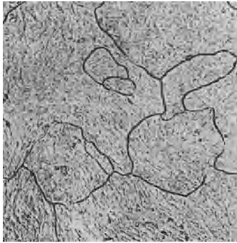
Abb. 105. Gefüge einer Rundstange von 40 mm Dmr., Querschliff, 200 \times .
