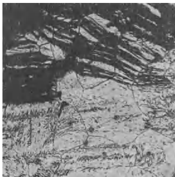
Abb. 127. Bevorzugte Korrosion längs der Basis bei Reinmagnesium, 140 \times .
