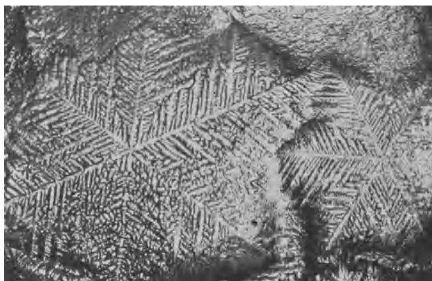
Abb. 11. Primärendrite von Magnesium auf der Oberfläche einer Gußmasse, 10×.
