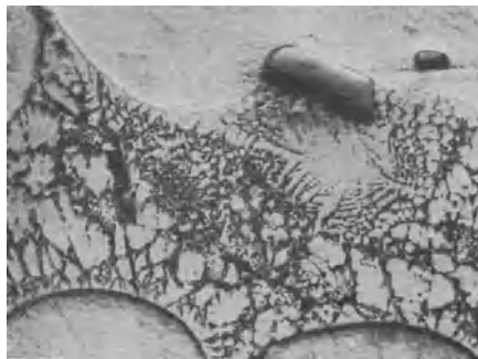
Abb. 60. Ternäres Eutektikum, vielleicht mit Eisen, 850 \times .
