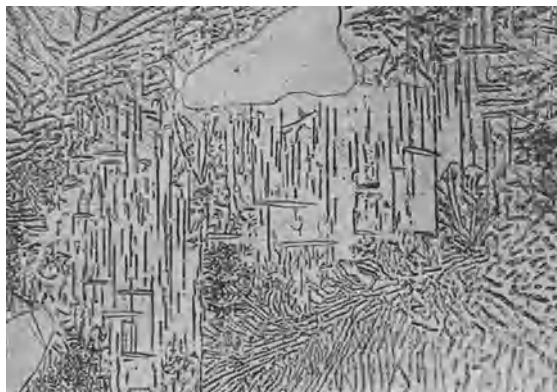
Abb. 36. Gerichtete Ausscheidungen auf den Basis- und Prismenflächen, 600×.
