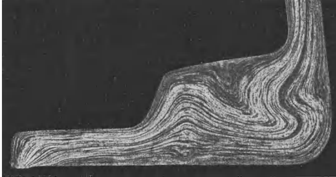
Abb. 240. Grobätzung an einem Schmiedeteil aus Mg-Al 6 mit fehlerhaftem Faserverlauf, nat. Gr.
