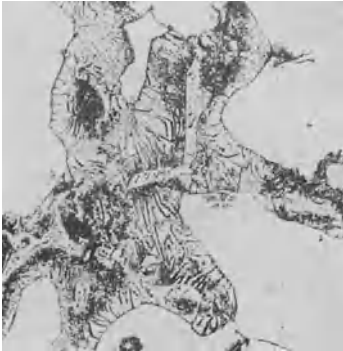
Abb. 148. Gußgefüge von Mg-Al 6 mit starker „Eutektoid“-Ausbildung, 200 ×.
