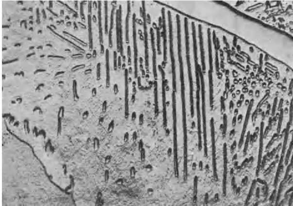
Abb. 31. \text{Al}_2\text{Mg}_3 und „eutektoid“ Zone, diese links unten nochmals gegen den Mg-Mischkristall deutlich abgesetzt, 900 \times .
