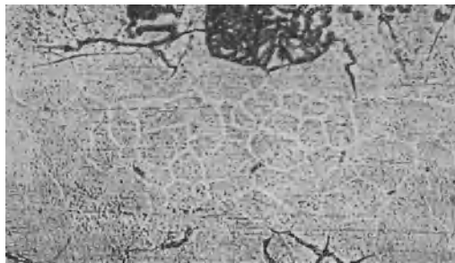
Abb. 180. Korngrenzen von rekristallisiertem Korn, noch ohne Korngrenzenausscheidungen, 900 \times .
