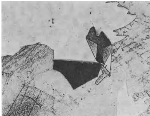
Abb. 6. Losgelöste und umgeklappte Ätzhaut, 150 \times .
