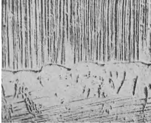
Abb. 80. Steil angeschliffene lamellenförmige Ausscheidungen von Mangan, 900 \times .
