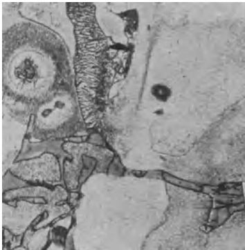
Abb. 133. \text{Mg}_2\text{Si} in Gußgefüge von Mg-Al 6, 300 ×.
