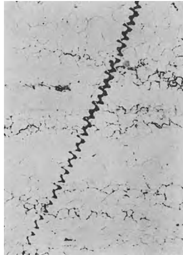
Abb. 1. Rollspur, verursacht durch harten Fremdkörper, 175 \times .
