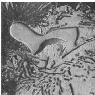
Abb. 142. \text{Al}_2\text{Mg}_3 , schräg ins Magnesium verlaufend, 900\times .
