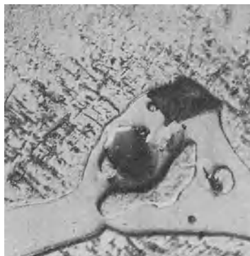
Abb. 143. \text{Al}_4\text{Mn} , \text{Al}_2\text{Mg}_3 und \text{Mg}_2\text{Si} im Magnesiummischkristall, 900\times .
