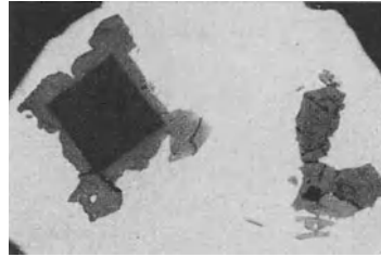
Abb. 25. Peritektischer Al-Mn-Kristall, 1000 \times .
