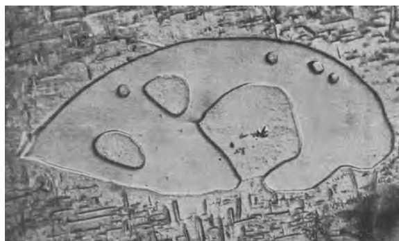
Abb. 30. Entartetes binäres Eutektikum aus Mg-Mischkristall und \text{Al}_2\text{Mg}_3 , Schräglicht, 1200 \times .
