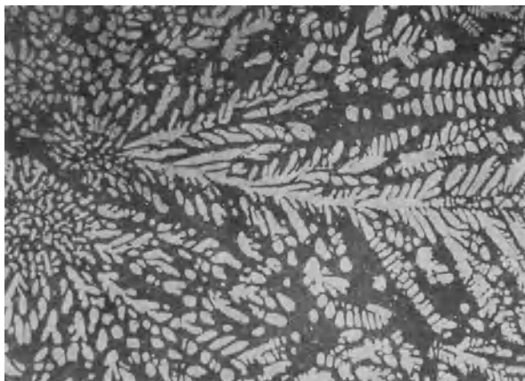
Abb. 28. Mg-Al-Versuchslegierung. Dendrite aus \text{Al}_2\text{Mg}_3 , 100 \times .
