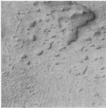
Abb. 146. Guß von Mg-Al 6, auf Gummi relief-poliert, ungeätzt, 900 \times .
