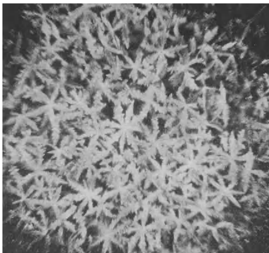
Abb. 52. Haufwerk aus Mg herausgelöster Eisendendrite, 30 \times .
