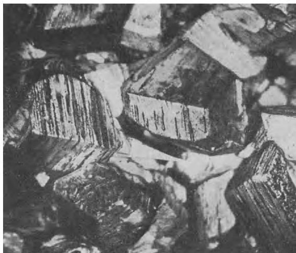
Abb. 128. Ätzung auf Pyramiden- und Prismenflächen von Magnesiumkristallen parallel zur Basis, 10 \times .
