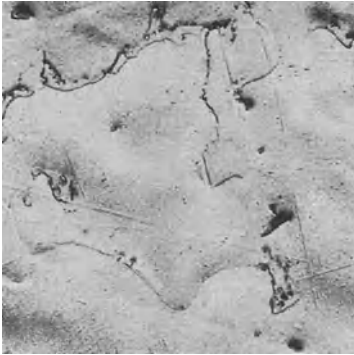
Abb. 139. Wie Abb. 136, \frac{1}{2} Stunde bei 400^{\circ} geglüht, 600\times .
