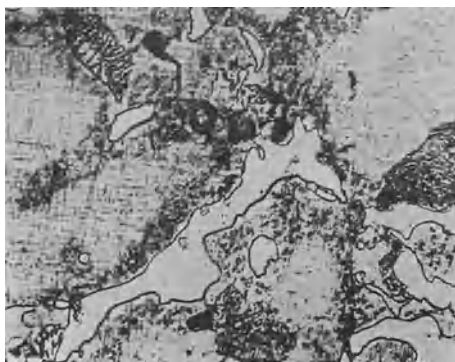
Abb. 29. \text{Al}_2\text{Mg}_3 im Gußgefüge von Mg-Al 6, 175 \times .
