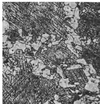
Abb. 185. Zwillinge aus gerichteter Preßstange, zur Sichtbarmachung angelassen, 100 \times .
