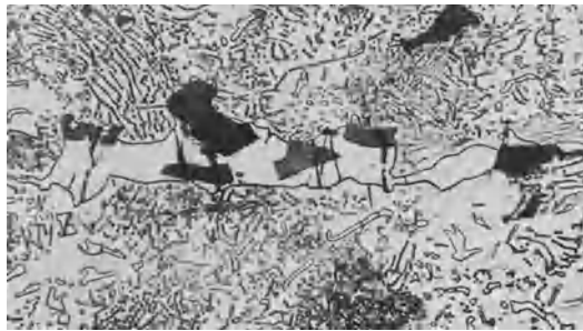
Abb. 165. Zeiliges \text{Al}_2\text{Mg}_3 mit eingelagerten \text{Mg}_2\text{Si} -Kristallen, beide Kristallarten im Zugversuch mehrfach gerissen, 700\times .
