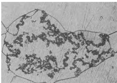
Abb. 76. Oberflächenkorrosion an einem mit der Basis in der Schlifffläche liegenden Korn, 100×.
