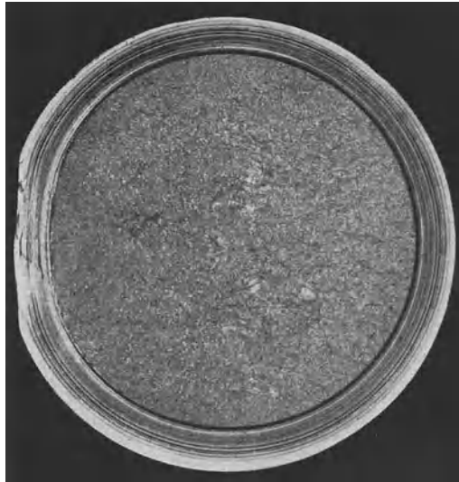
Abb. 247. Bruchgefüge einer Strangpreßstange aus Mg-Mn von 70 mm Dmr., nat. Gr.
