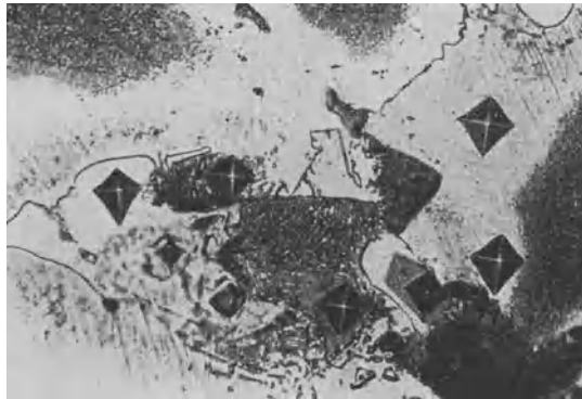
Abb. 145. Mikrohärteeindrücke in die Phasen Mg-Mischkristall, \text{Al}_2\text{Mg}_3 , \text{Mg}_2\text{Si} , „Eutektoid“ und eine unbekannte ternäre Phase, 500 ×.
