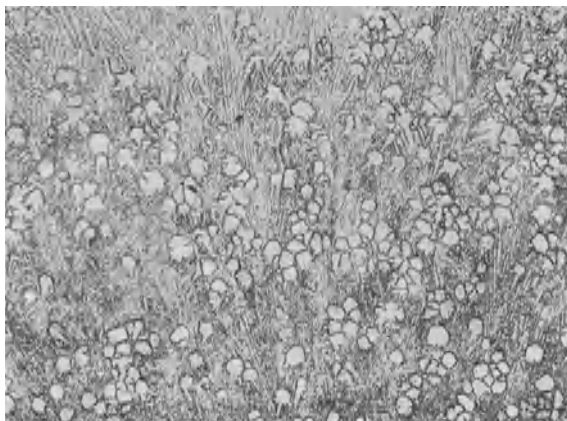
Abb. 94. Magnesiumdendrite in rasch erstarrtem Mg-Mn-Guß, 10 \times .
