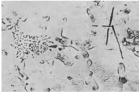
Abb. 26. Binäres und ternäres Eutektikum in einer Mg-Al-Mn-Legierung, 750 \times .
