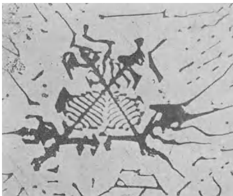
Abb. 48. \text{Mg}_2\text{Si} -Primärkristall nach dem Umschmelzen, 800 \times .
