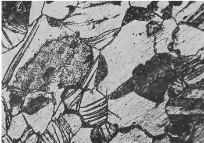
Abb. 193. Zwillinge, in der Schliffebene liegend, und „Eutektoid“, 600 \times .
