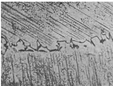
Abb. 58. Eisen, auf Korngrenzen ausgeschieden, 400 \times .
