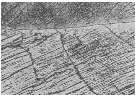
Abb. 92. Mikrokorngrenzen aus langsam gekühltem Guß, 100 \times .
