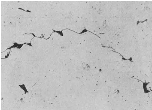
Abb. 154. Mikrolunker, durch Riß verbunden, 150 \times .
