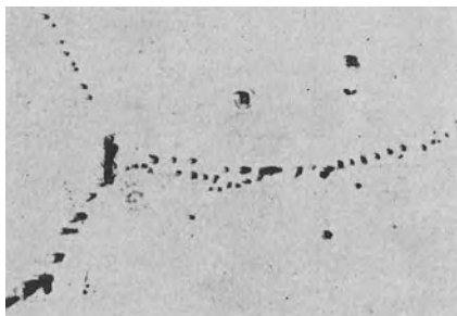
Abb. 57. Eisen, auf Korngrenzen abgeschieden, 200 \times .
