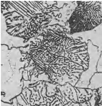
Abb. 150. Gefügebild von „Eutektoid“, 600 ×.
