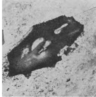
Abb. 62. Nichtmetallischer Schlackeneinschluß, 1000 \times .
