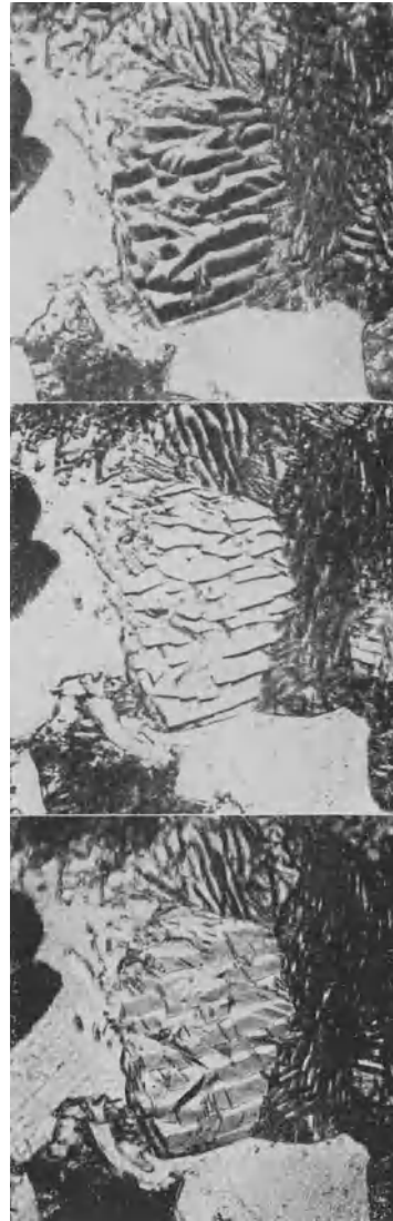
Abb. 176. „Eutektoid“ aus einer Preßstange, im normalen und im Schräglicht mit um 180^\circ wechselnder Einfallsrichtung, 850\times .
