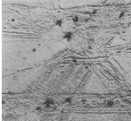
Abb. 101. Zwillingsbildung in Mg-Mn-Guß, durch nachträgliches Quetschen erzeugt, 400 \times .
