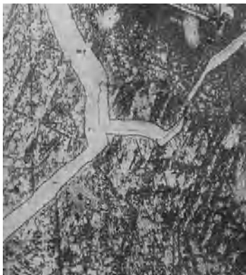
Abb. 7. Aufgeplatzte und verschobene Ätzhaut, die darunterliegenden Korngrenzen freigebend, 150 \times .
