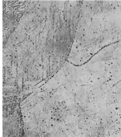
Abb. 66. Reinmagnesium mit Korngrenzenverunreinigungen, jedoch gleichem Reinheitsgrad wie Abb. 65, 200 \times .
