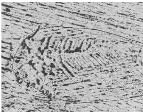
Abb. 95. Manganausscheidungen zwischen Magnesiumdendriten, 100 \times .
