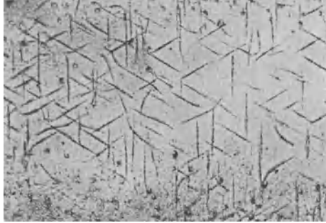
Abb. 20. Manganausscheidungen bei sehr hohem Mangangehalt, gerichtet, 350\times .
