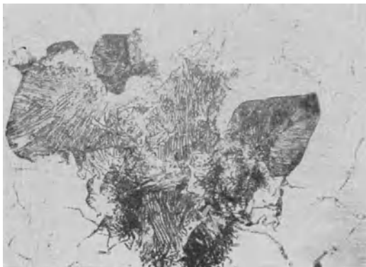
Abb. 175. „Eutektoid“-Zonen, innerhalb der Körner mit glatten Grenzen wachsend.
