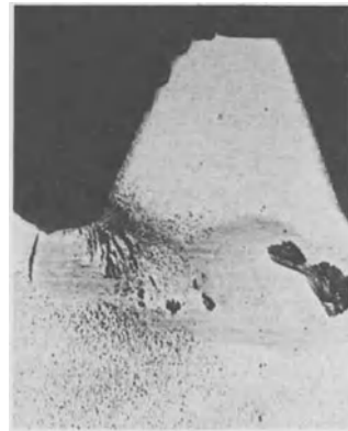
Bild 20. Mit magnetischer Durchflutung sichtbargemachte Risse im Zahnfußgebiet
