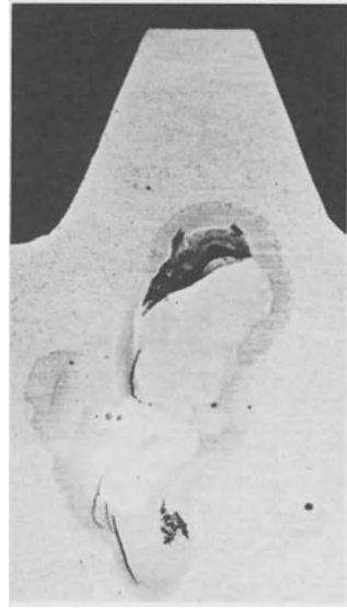
Bild 19. Risse in einer Heftschweißstelle mit magnetischer Durchflutung sichtbar gemacht
