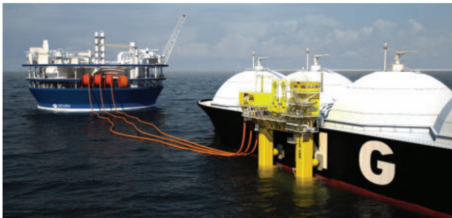
LNG transfer from the Sevan FLNG unit using the HiLoad LNG system. (Image courtesy Sevan Marine)
