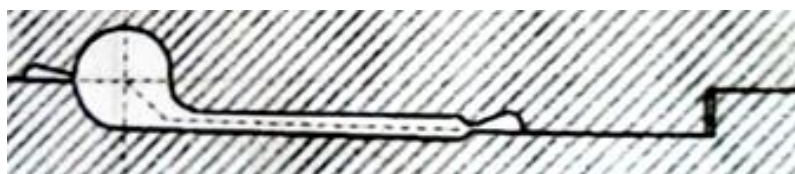
شکل ۵: خط جدایش شکسته در طراحی یک طرفه
