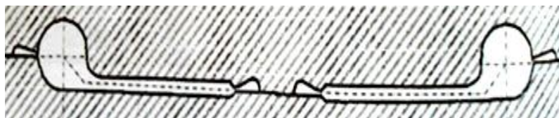
شکل ۶: خط جدایش شکسته در طراحی دو طرفه
