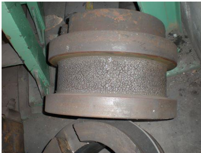
شکل ۶-۱۱: عکسی از خراب شدن غلتک چدنی بر اثر ترکهای ناشی از تنشهای مختلف کاری [۷]
