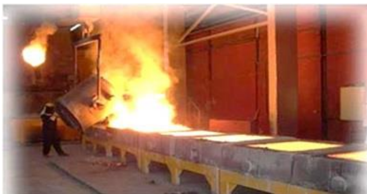
شکل ۱۰: شمش (اسلب) ریزی تکباره در کارخانه نورد و تولید قطعات فولادی، تهران
