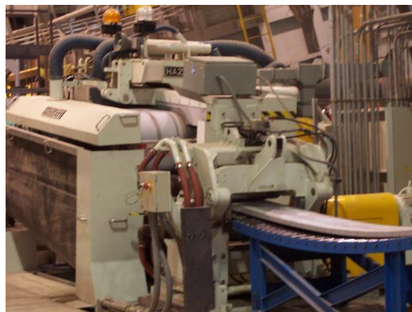
شکل ۳-۶: ماشین ریخته‌گری پیوسته ورق (کاستر) آلومینیوم، و استفاده شل در آنها
