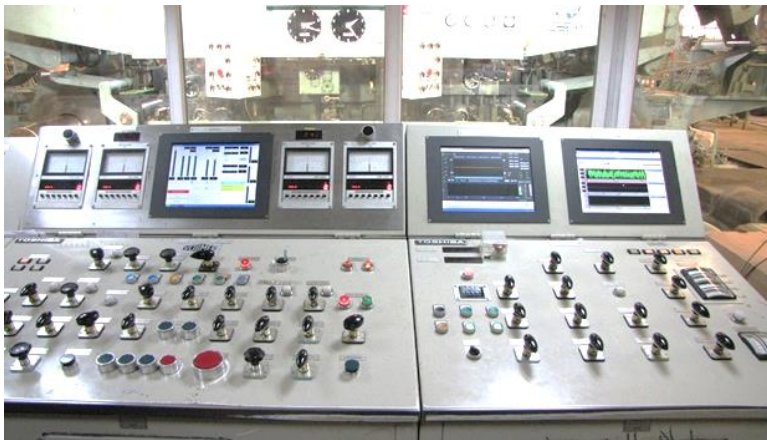
شکل ۱۴: عکسی از سیستم کنترلی نورد سرد
