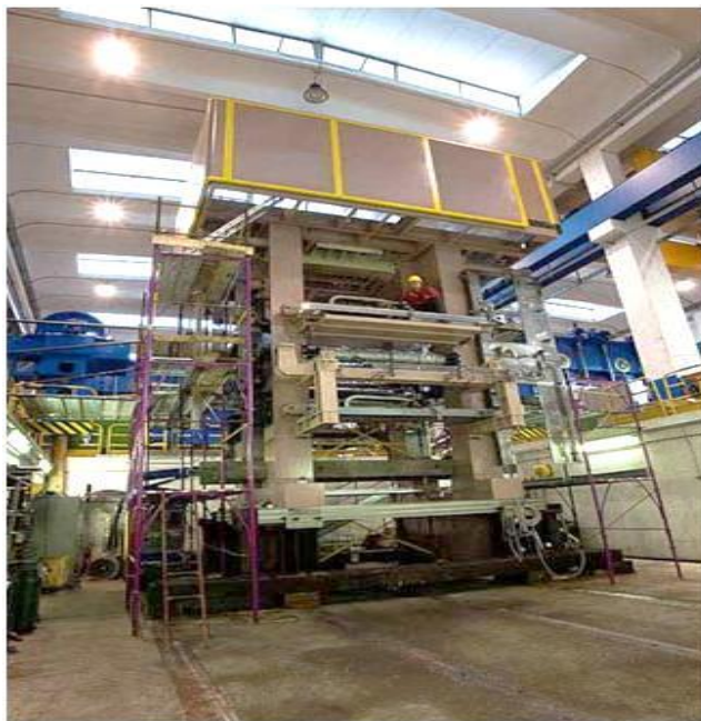
شکل ۲: یک استند نورد گرم ورق آلومینیوم با عرض ۴۳۰۰ میلیمتر در حال نصب، این استند که بوسیله گروه گالبیاتی طراحی و ساخته شده است بیش از ۲۵۰ تن وزن دارد [ ۳ ]
