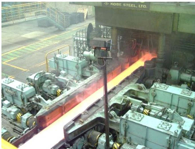
شکل ۱۲: عکسی از یک استند دو غلتکه نورد گرم برای مس و آلیاژهای آن
