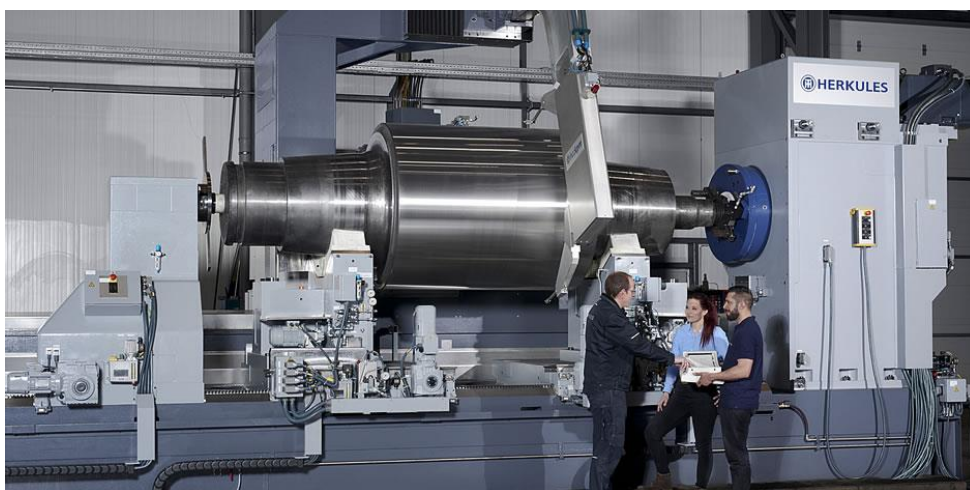
شکل ۶-۱۶: عکسی از یک ماشین سنگ غلتک مدرن برای سنگ‌زنی غلتک‌های پشتیبان تا وزن ۵۵ تن با دقت میکرون. ( ماشین هرکولس آلمانی با بیش از ۱۰۰ سال تجربه)
