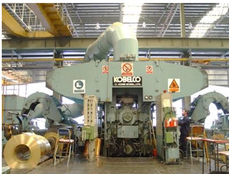
شکل ۱۳: عکسی از یک استند ۴ غلتکه نورد سرد ساخت ژاپن
