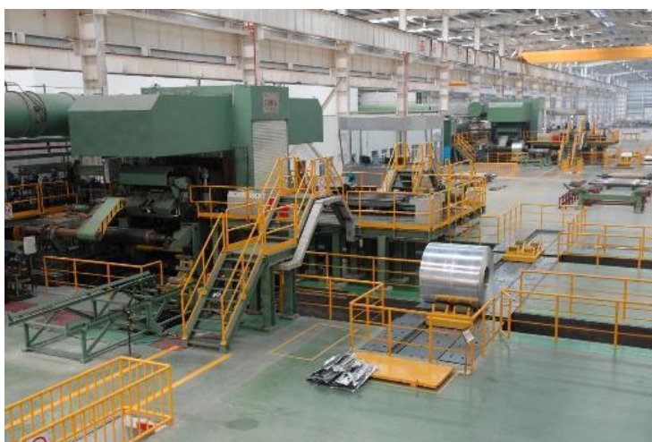
شکل ۴: کارخانه نورد با دو استند نورد سرد آلومینیوم [۴]
