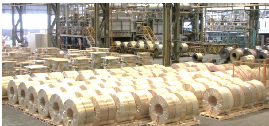
شکل ۱۵: عکسی از کارخانه مس شهید باهنر که در آن کوره‌های آنیل و کویل‌های مسی بسته بندی شده و آماده برای ارسال به مشتریان دیده می‌شود.
