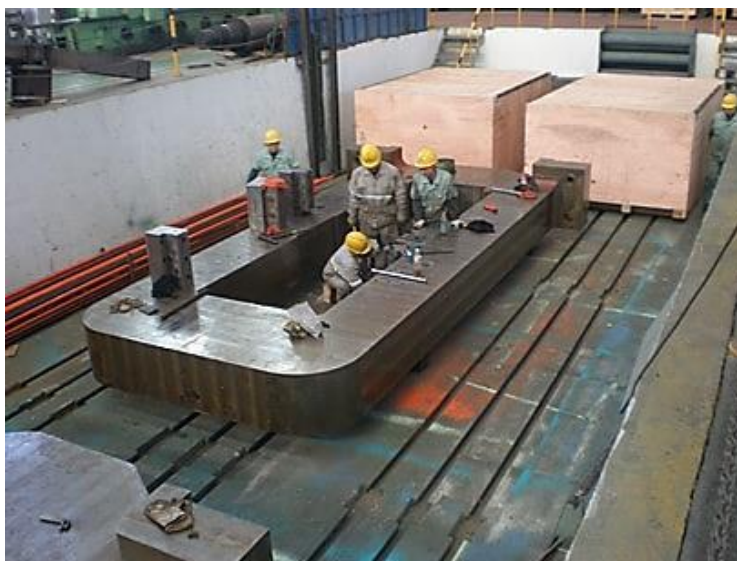
شکل ۶: عکسی از یک استند نورد چهار غلتکه در حال ساخت
