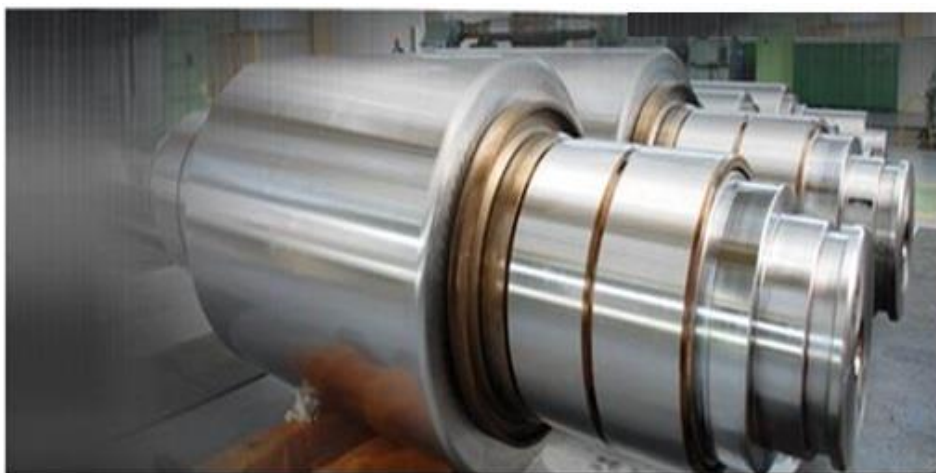
شکل ۶-۸: تصویری از غلتک نورد تخت (غلتک پشتیبان آهن‌گری شده) [۷]
