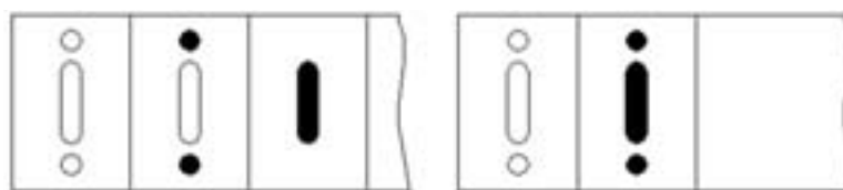
شکل ۱۲ استفاده از سه ایستگاه به جای دو ایستگاه برای تقویت جداره ماتریس
