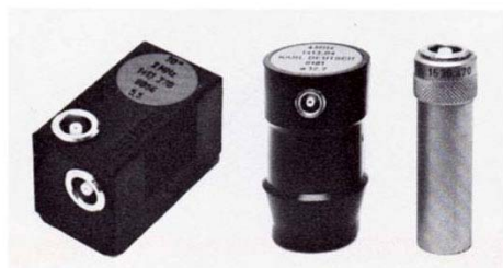
شکل (5-9): تست ماوراء صوت - نمونه دستگاه حسگر
