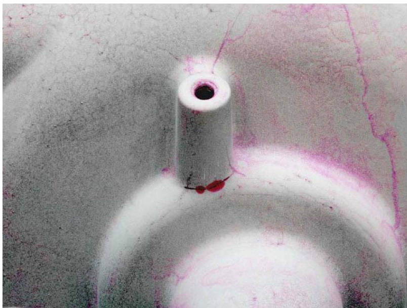
شکل (3-3 ب): روش تست نافذ - مثال روش سفید - قرمز
