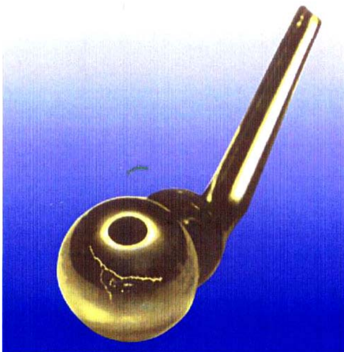
شکل (3-3 ج): روش تست نافذ مثال روش درخشان.
