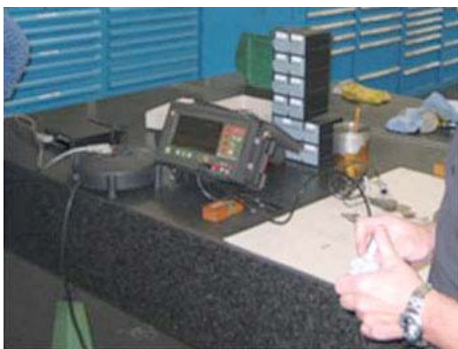
شکل (5-9): تست ماوراء صوت - نمونه دستگاه حسگر
