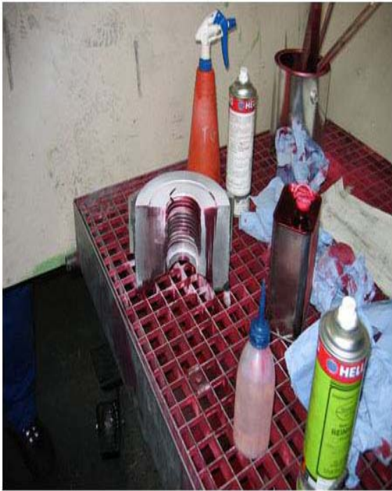
شکل 3-4: نمونه تجهیزات بکار رفته در تست نافذ
