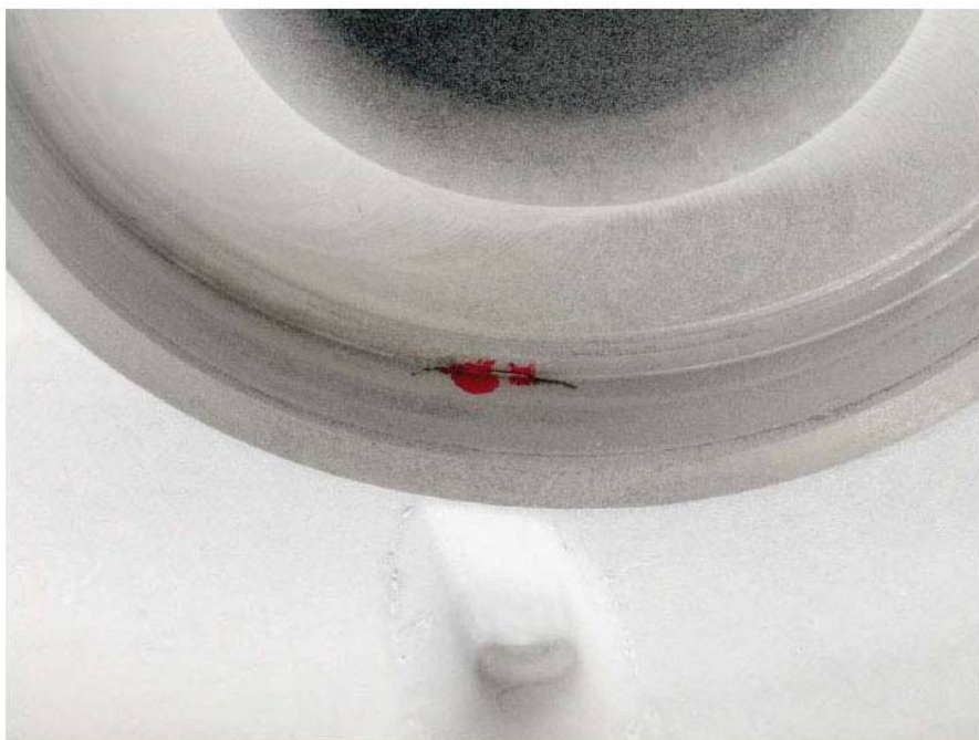
شکل (3-3 الف) : روش تست نافذ - مثال روش سفید - قرمز
