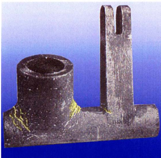
شکل (3-3 ه) : روش تست نافذ - روش درخشان
