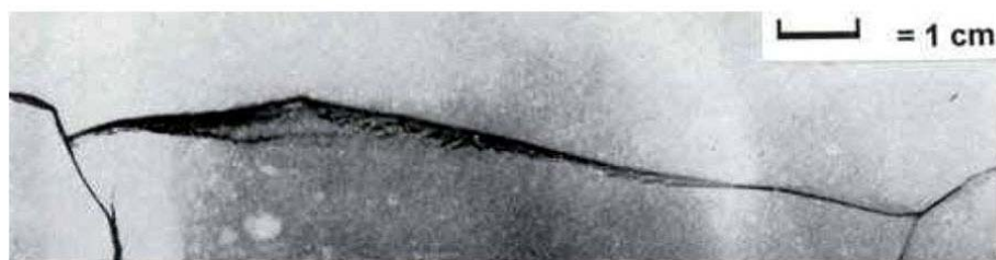
St52, Wandd. 17 mm : تیر پاره شده یک پل
