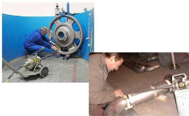
شکل ( 9- ج): تست تشعشعی - نمونه کاربردها
