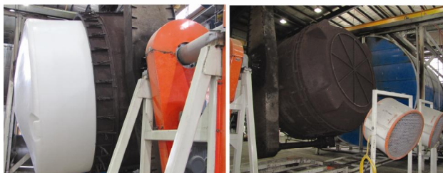
۶- تخلیه محصول از قالب
