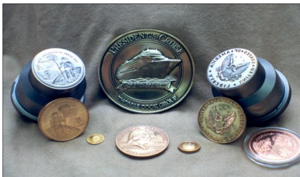
شکل ۳-۲۸ ابزار و سکه های تولید شده بوسیله آن ( فرایندهای مدرن سکه زنی )
