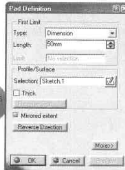
شکل ۳-۳۰۱ اجرای فرمان Pad با مقدار رشد 50 واحد و فعال کردن گزینه Mirrored extent
