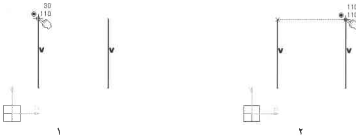
شکل ۳-۳۳۴ انتخاب نقطه ابتدا (۱) و نقطه انتها (۲) برای رسم کمان
