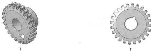
شکل ۲-۴۵ روش اجرای فرمان Normal View؛ انتخاب وجه یا صفحه مورد نظر قبل از اجرای فرمان (۱)، قرار گرفتن نمای دید عمود بر موضوع انتخاب شده (۲)
