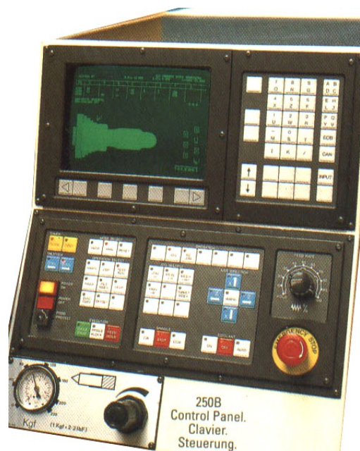
نمایشگر، صفحه کلید و صفحه کنترل تراش باکسفورد
