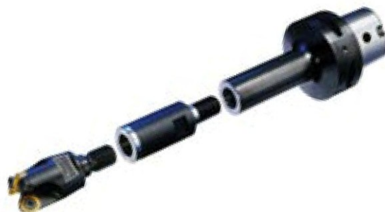
مکانیزمهای استاندارد نگاه دارنده های ابزار در ماشین فرز و بورینگ
