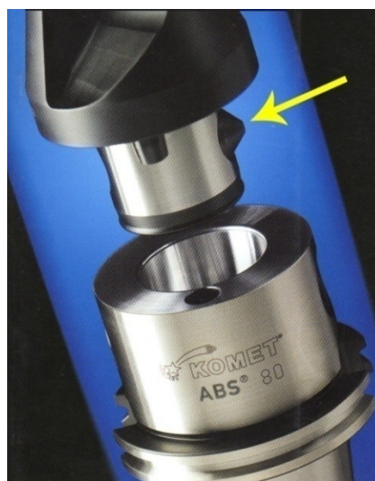
سیستم ابزار گیر ABS شرکت کومت آلمان با زائده قفل شونده
