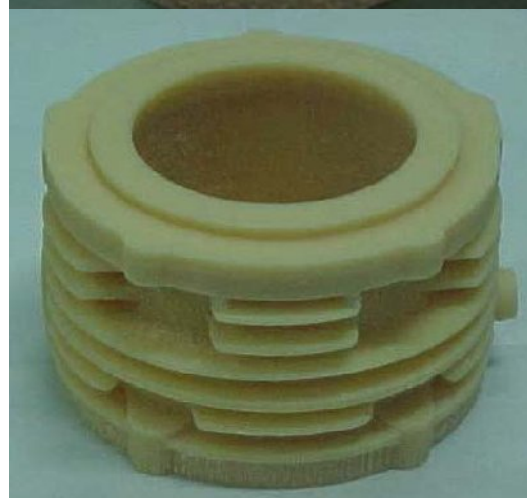
شکل ۱-۵- مدل پروتوتایپ نمونه، ساخته شده از سه جنس مختلف بوسیله پیرینتر های سه بعدی
